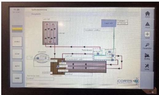
La valeur du pH est mesurée par deux pH-mètres et l'acide sulfurique est automatiquement dosé dans le lisier
